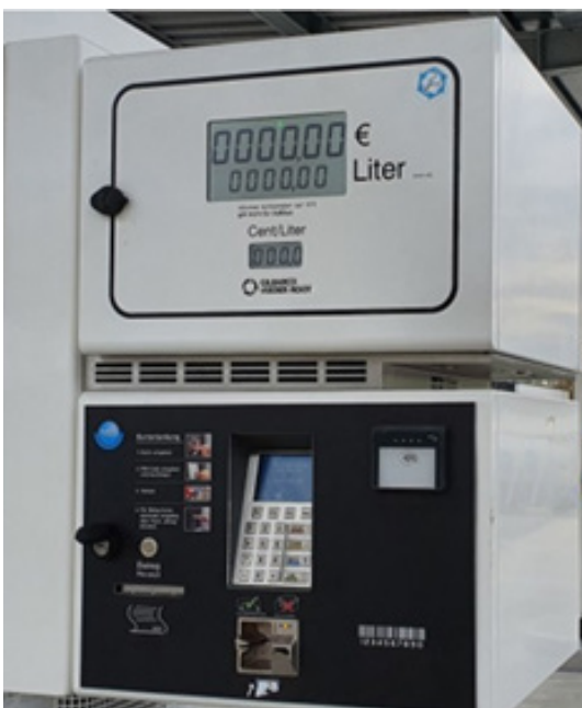
Tankautomat eingebaut in Zapfsäule (CRID)
